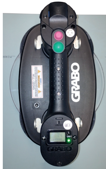
Adapterplatte mit aufgesetztem Vakuumsaugheber mit darunter liegendem Blech und Druckplatte. Links: Anwendung mit Saugheber Typ OTTOVAC (mirror tec ArtNr: 070ng400). Rechts: Empfohlene Anwendung mit Saugheber Typ „GRABO PRO“ (mirror tec ArtNr.: 070ng500)
